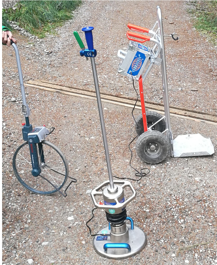
Abbildung 3.12: Equipment bei den Feldmessungen: Messrad, dynamische Lastplatte mit leichtem Fallgewicht und Sackkarre mit Messcomputer
